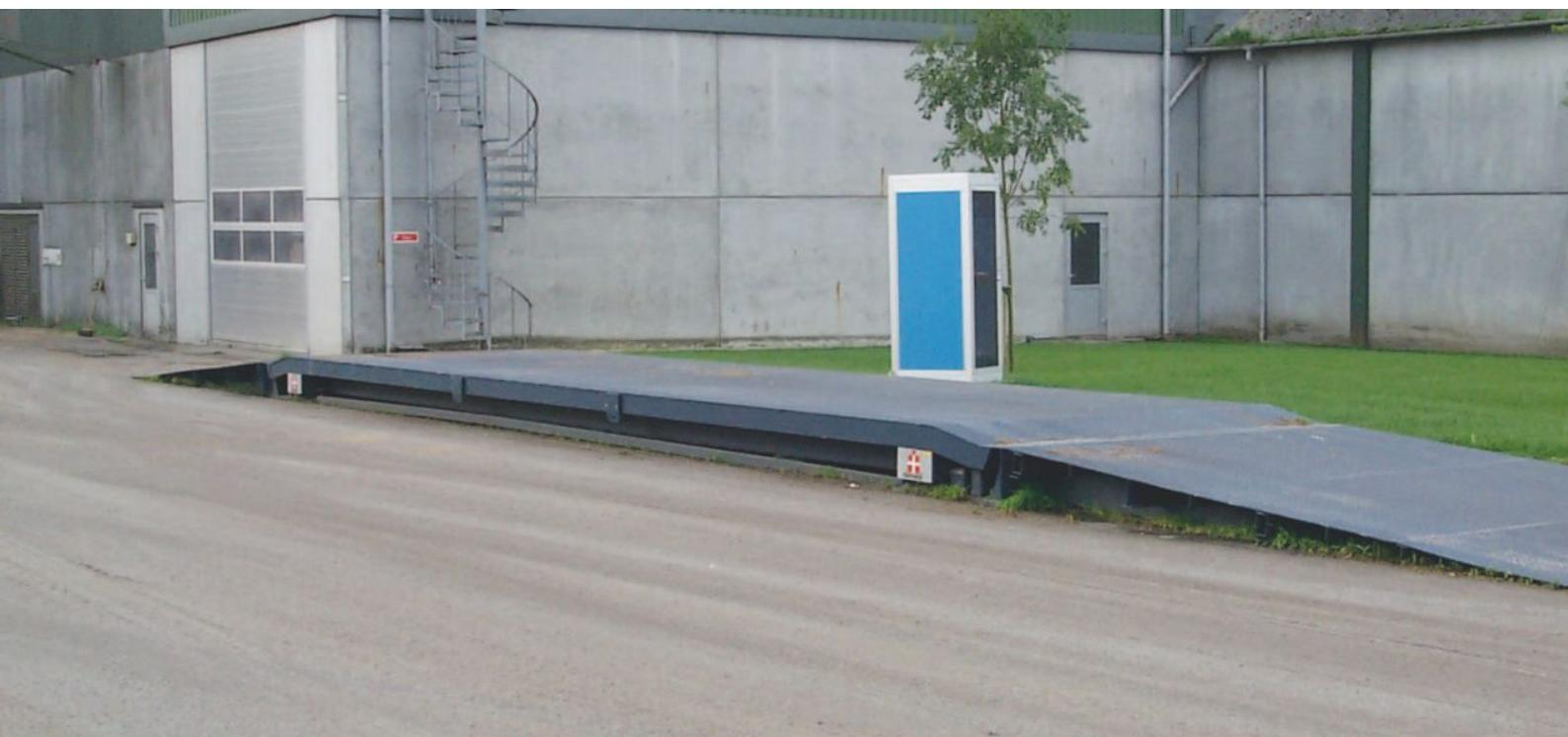
Brovægt, model DF er en brovægt specielt udviklet til at kunne flyttes. Den har bundramme med integrerede ende-gavle, digitale vejeceller monteret i pendullejer og en vejeplatform opbygget i stål. Brovægten er forsynet med beslag, så hele konstruktionen er flytbar og kan flyttes til et andet anvendelsessted.
